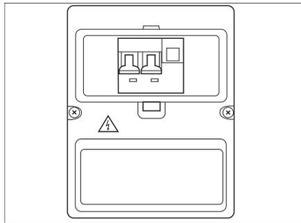
Bild 54 230-Volt-Sicherungsautomat
