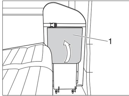
Bild 31 Ablage ausklappen
