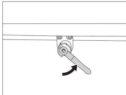
Bild 65 Abwasserhahn öffnen
