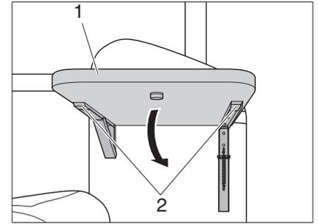
Bild 32 Ablage einklappen
