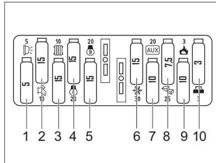
Bild 55 12-Volt-Sicherungen in der Modulbox (Abb. ähnlich)
