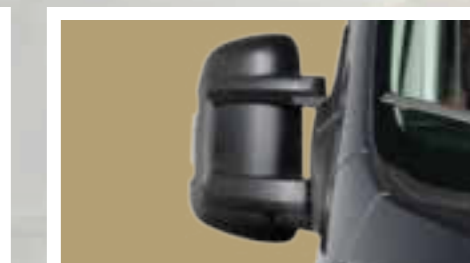
RÜCKSPIEGEL ELEKTRISCH VERSTELL- UND BEHEIZBAR
