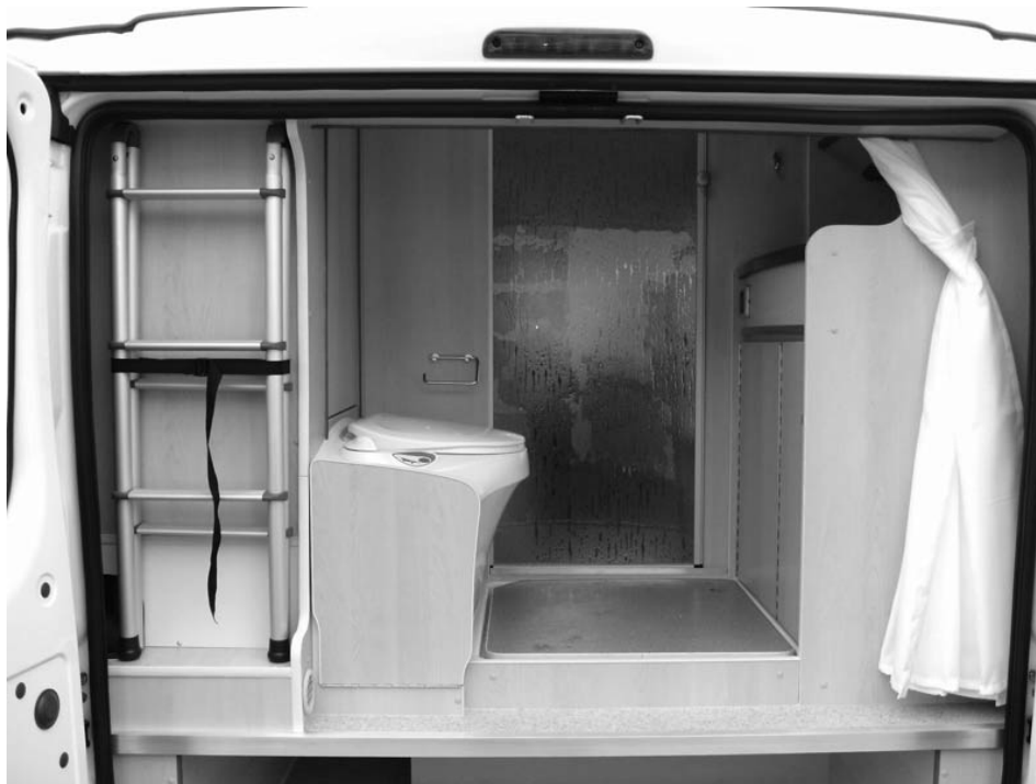
Nasszelle mit Dusche und Toilette bei geöffneten Hecktüren
